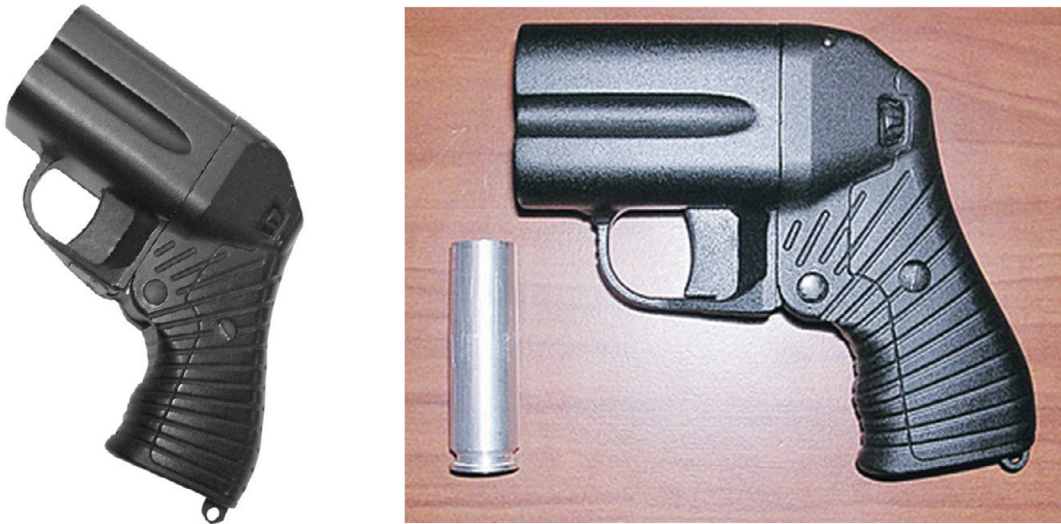
Рисунок 7. Пистолет самообороны бесствольный ПБ-4СП [2]
